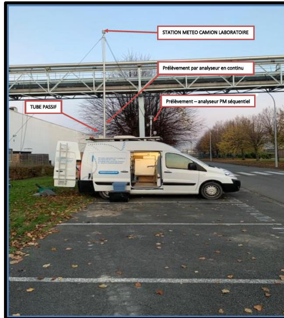
Figure 135. Photo illustrant les équipements du camion-préleveur
