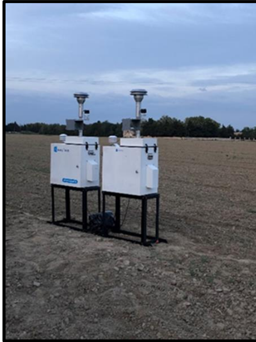
Figure 127. Illustration d'un préleveur séquentiel dichotomique et de tubes passifs
